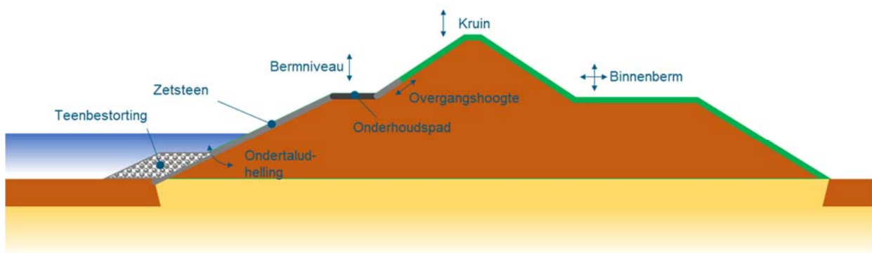
Figuur 3-5: Schematisatie dijkprofiel met ontwerprijheden en kenmerken
